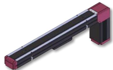
※水平横立て、水平天吊り姿勢は、特にステンレスシートにたるみやずれが生じる可能性があります。そのまま使用を続けるとステンレスシートの破断などの不具合が発生しますので、日常点検を行い、たるみやずれが生じている場合にはステンレスシートの調整を行ってください。
