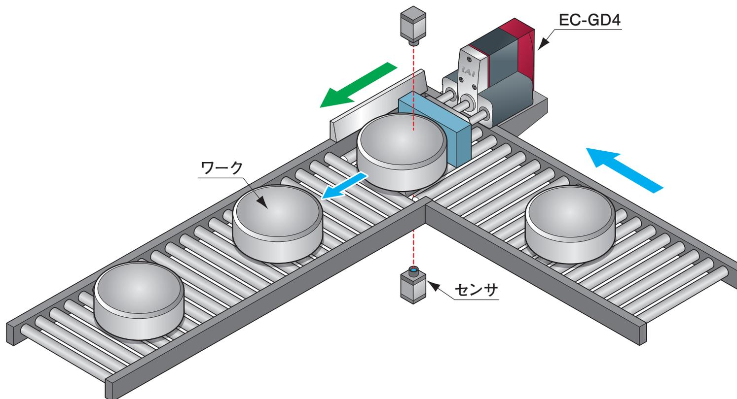
**解説** エア源が無い場合、これまで人手で移載を行っていましたが、エレスリンダーにより自動化ができました。加速度設定ができるため、エアシリンダーと比べてワークへの傷を防ぐことができます。
