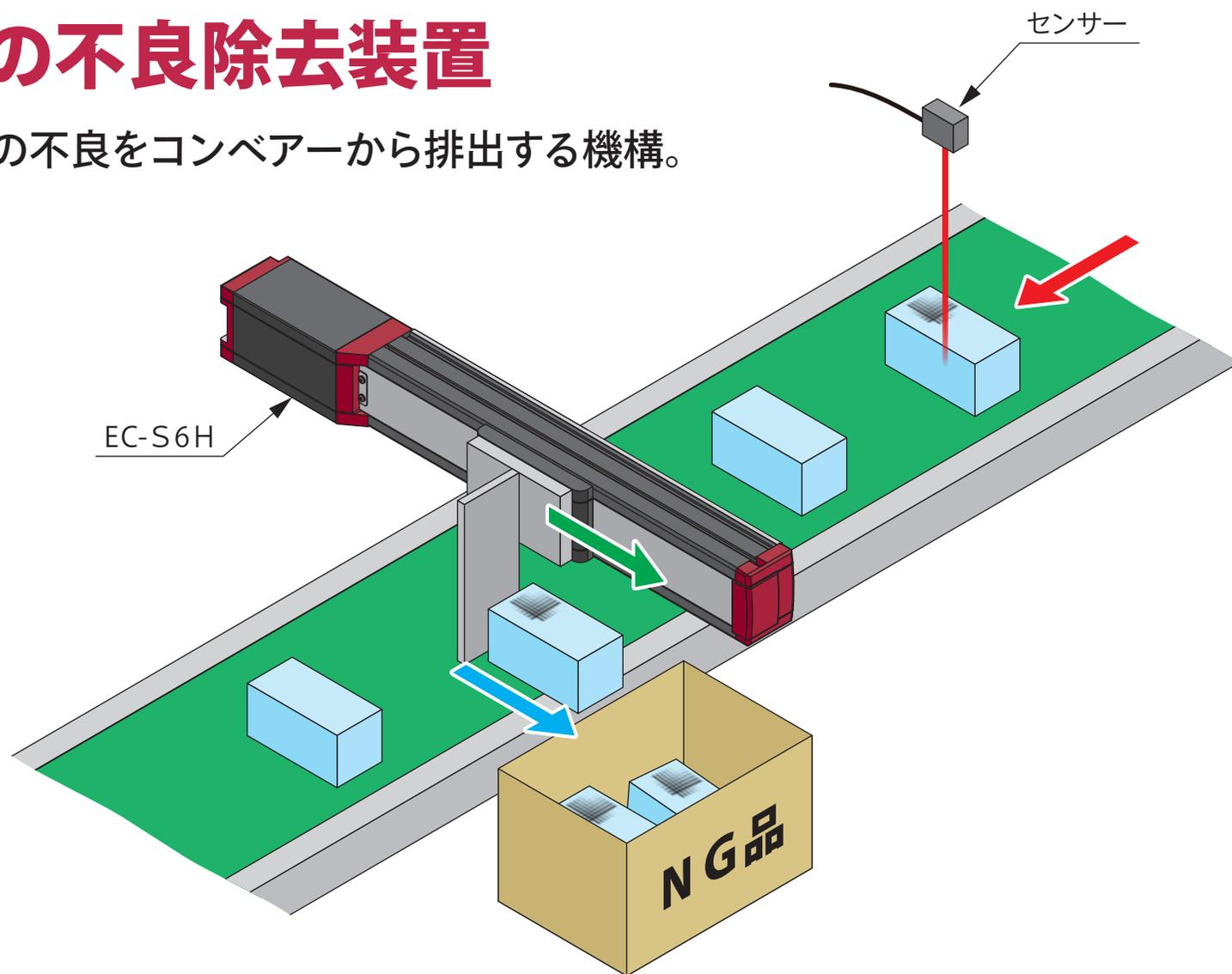
**解説** 不良品センサー検出、前進信号 ON 後の動きがエアシリンダーより早く、除去後、待機位置への戻りも早いため、コンベアー速度をアップすることができました。
