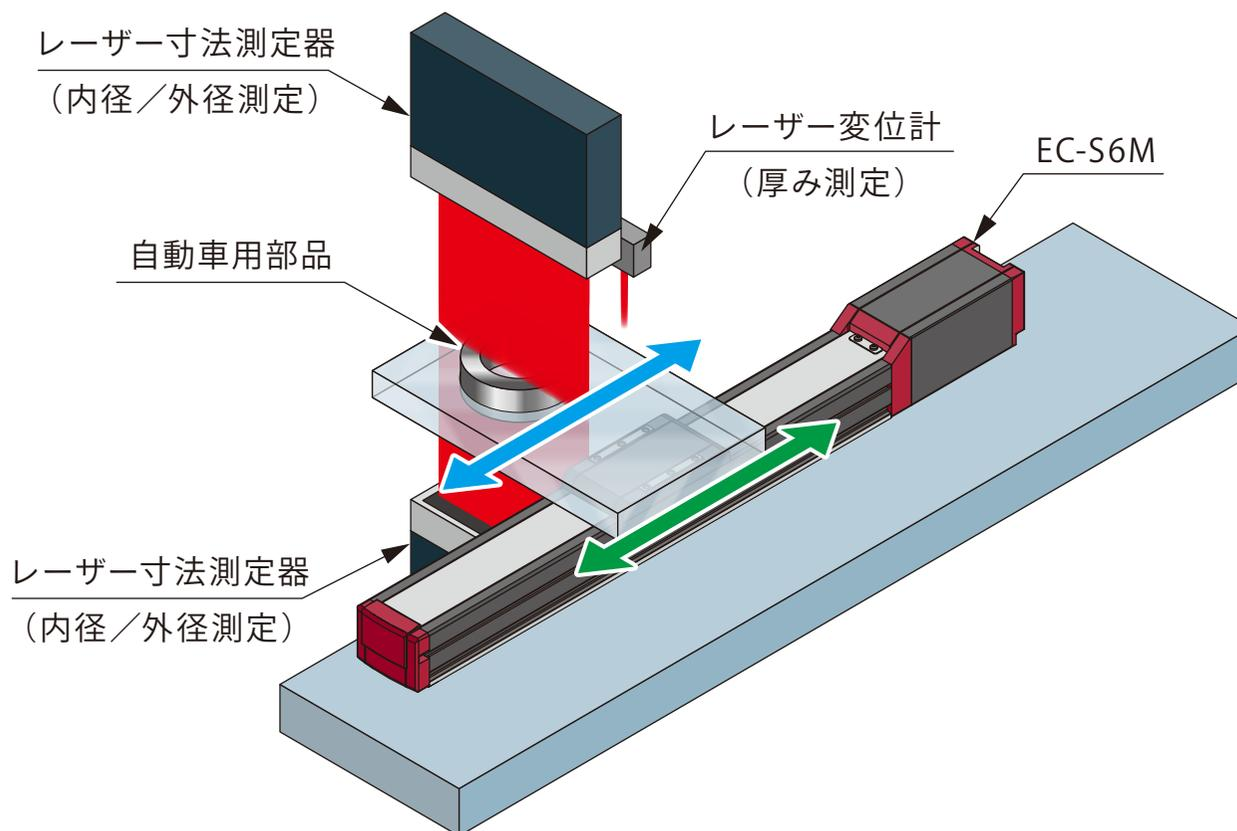
**解説** レーザー寸法測定器の帯状レーザーを上下からはさみ込むように部品の内径/外径を測定します。等速動作の往復動作を行う必要があり、2点位置設定、速度設定がカンタンで、リニアガイドも内蔵したエレシリンダーは最適でした。
