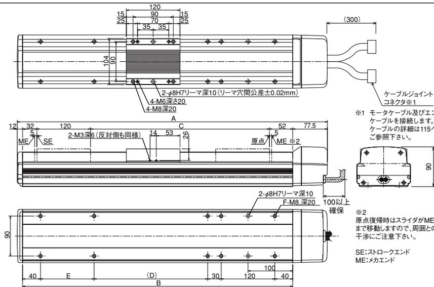
\*1 モータケーブル及びエンコーダケーブルを接続します。ケーブルの詳細は115ページをご参照下さい。
