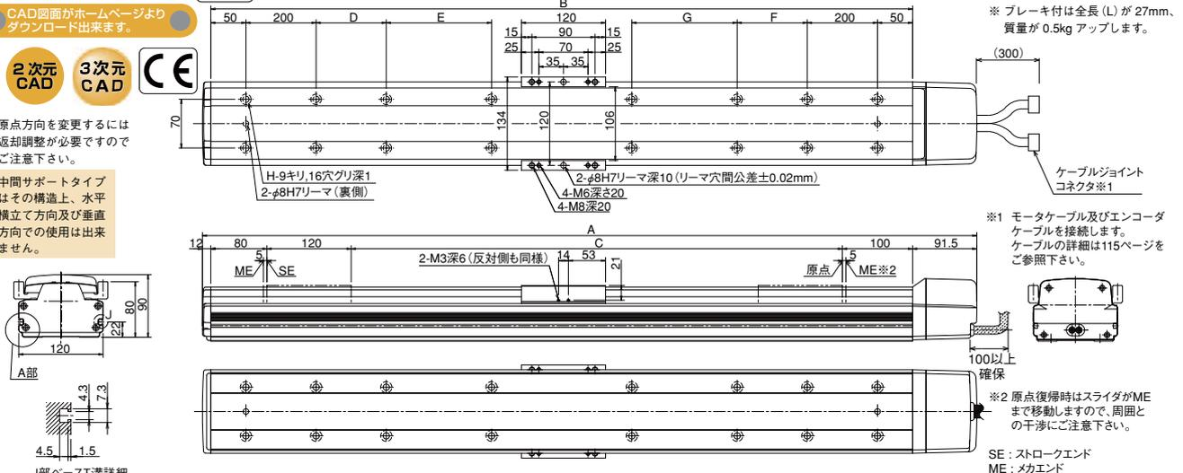
■ストローク別寸法・質量・最高速度
