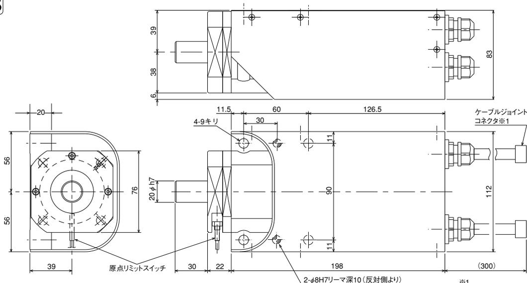
※1 モータケーブル及びエンコーダケーブル、リミットスイッチケーブルを接続します。ケーブルの詳細は115ページをご参照下さい。
