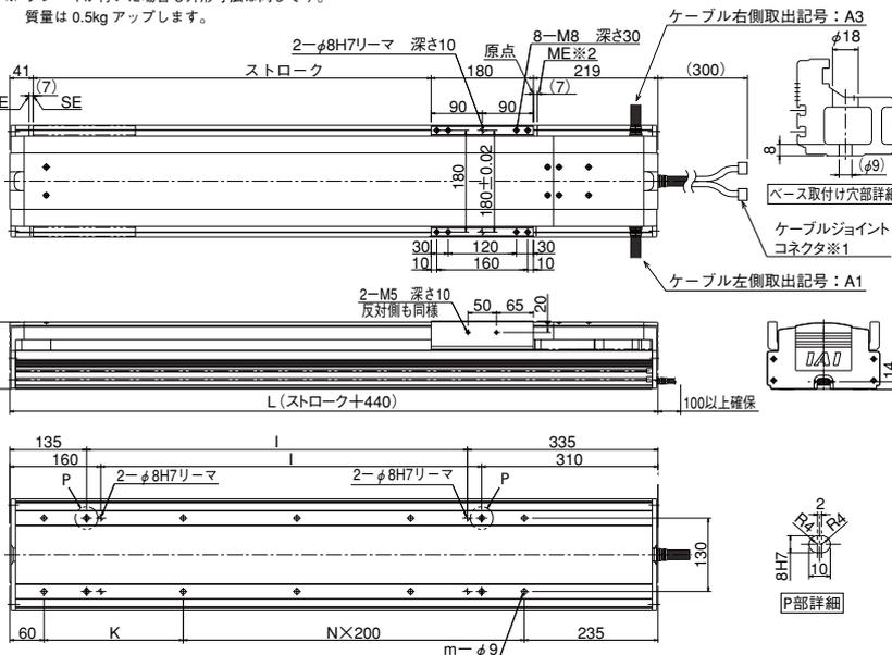
※1 モータケーブル及びエンコーダケーブルを接続します。ケーブルの詳細は115ページをご参照下さい。
