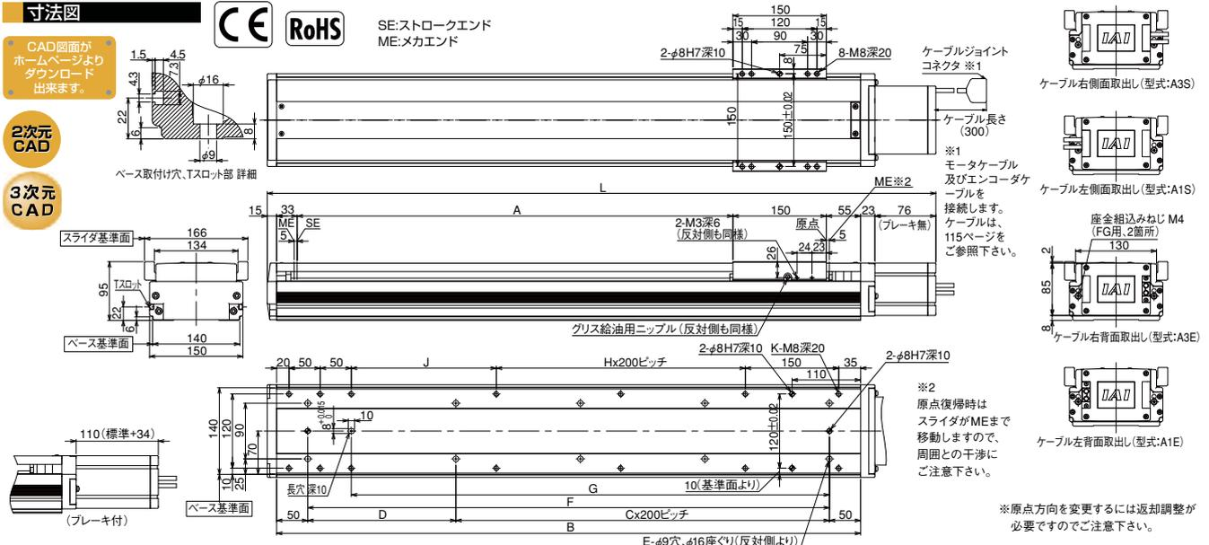
■ストローク別寸法・質量・最高速度
