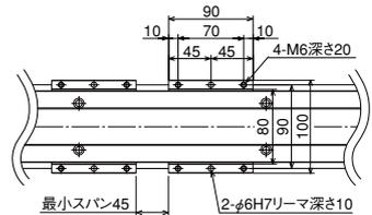
※ダブルスライダの場合、ストロークはスライダの長さ+スライダ間のスパンの分だけ短くなります。
