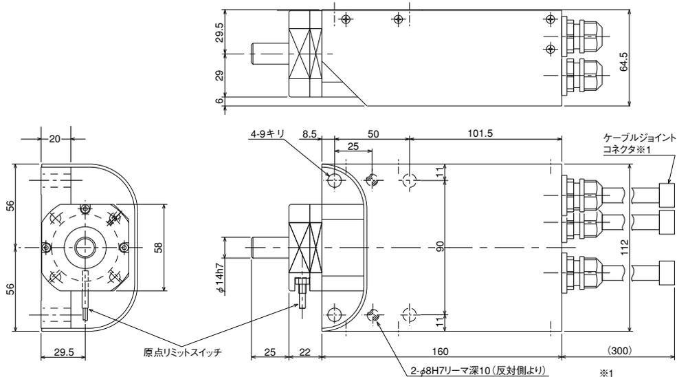
※1 モーターケーブル及びエンコーダケーブル、リミットスイッチケーブルを接続します。ケーブルの詳細は115ページをご参照下さい。
