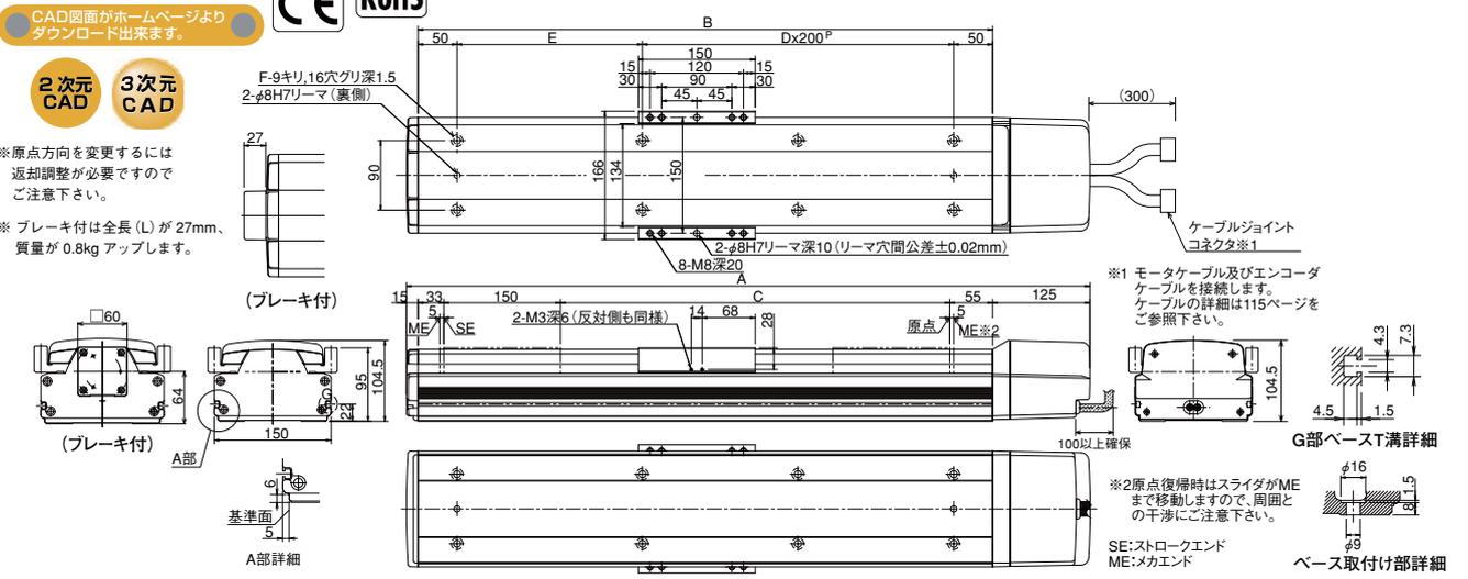
**■ストローク別寸法・質量・最高速度**
