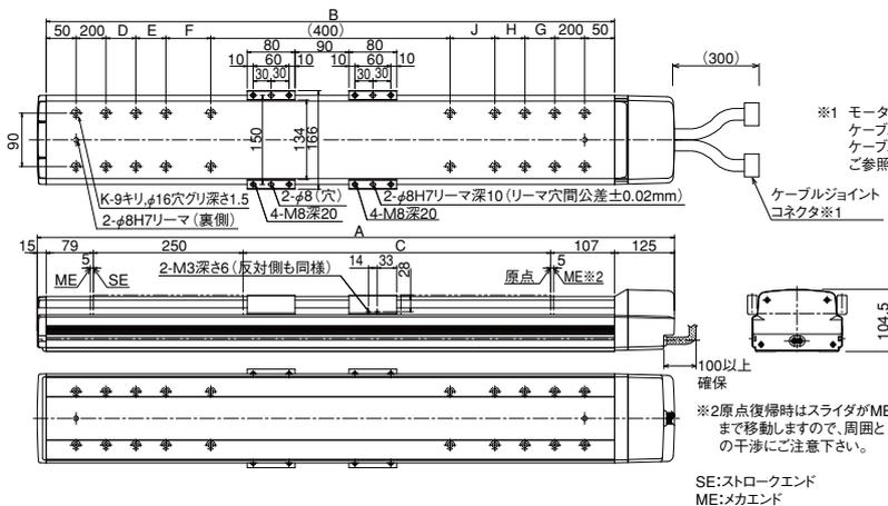
\*ブレーキ付は全長(L)が27mm、質量が0.8kgアップします。
