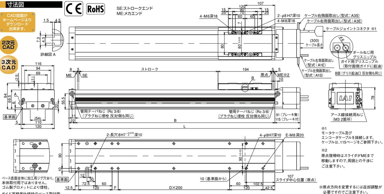
**ストローク別寸法・質量・最高速度**
