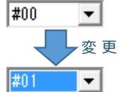
各スレーブユニットの状態（リモートI/O通信中）を確認する場合は、プルダウンリストから確認したいスレーブのノードアドレスを指定します。
