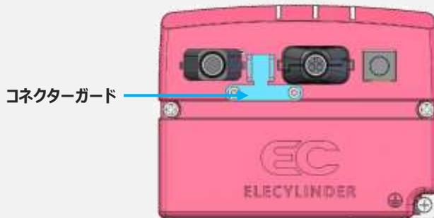
コネクターガードとコネクター部を結束バンドで固定することで、ケーブルの振動などによるコネクター部の接点不良を抑制できます。
