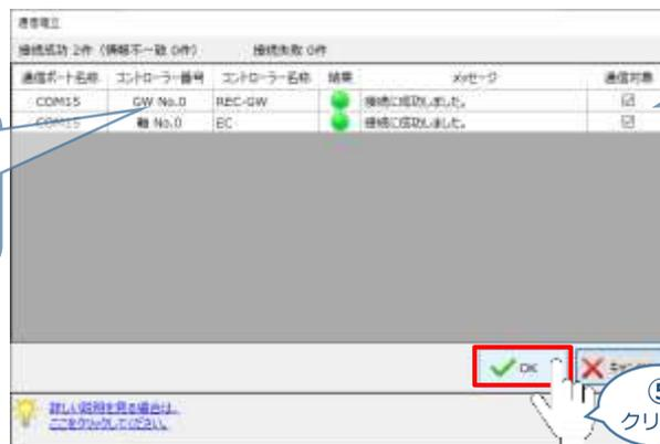
“通信確立”画面には④で選択したCOM No.に接続しているコントローラもしくは、ドライバーが表示されます。
