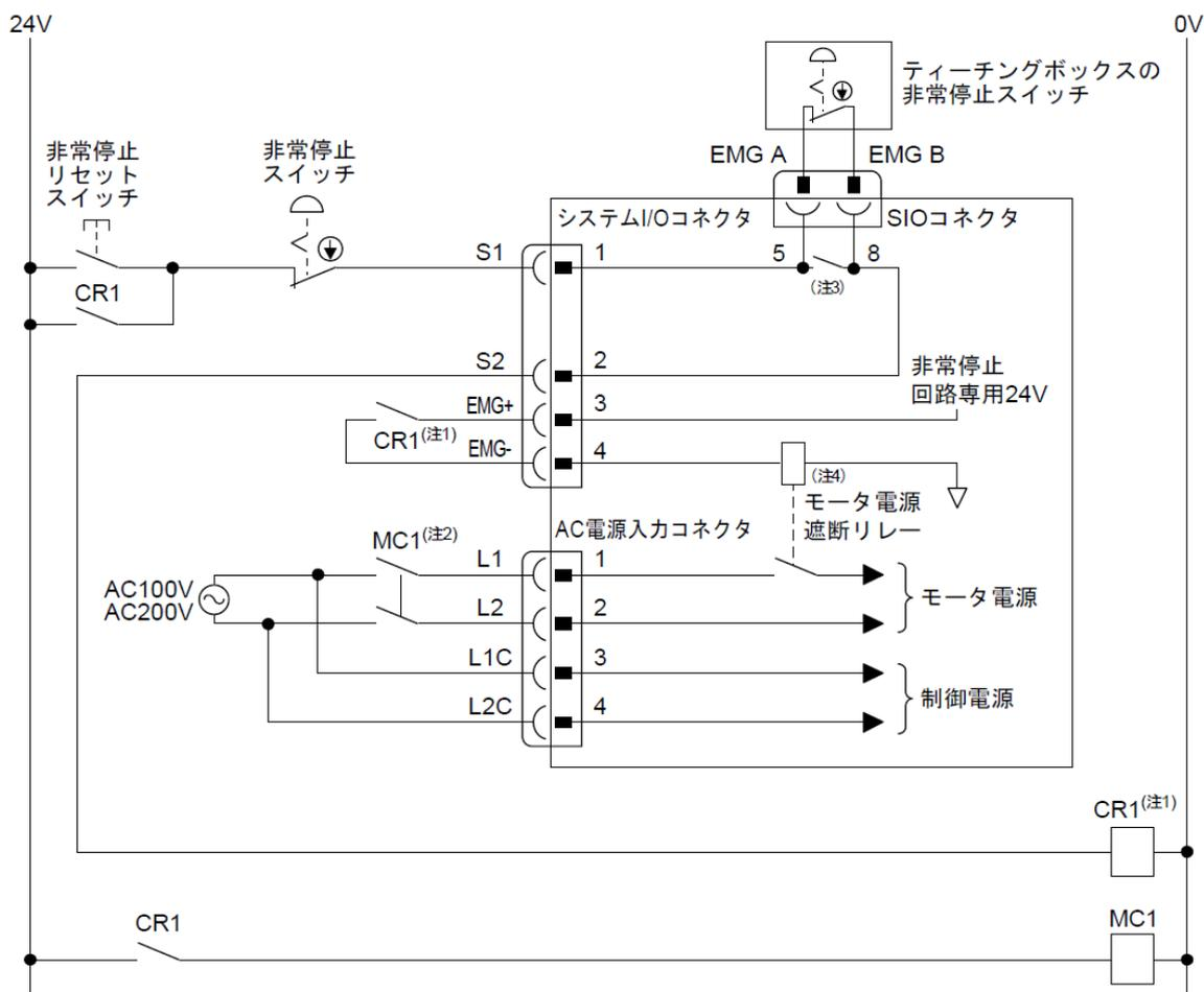
図 4-1 SCON-CA/CB タイプ 電源・非常停止配線例
